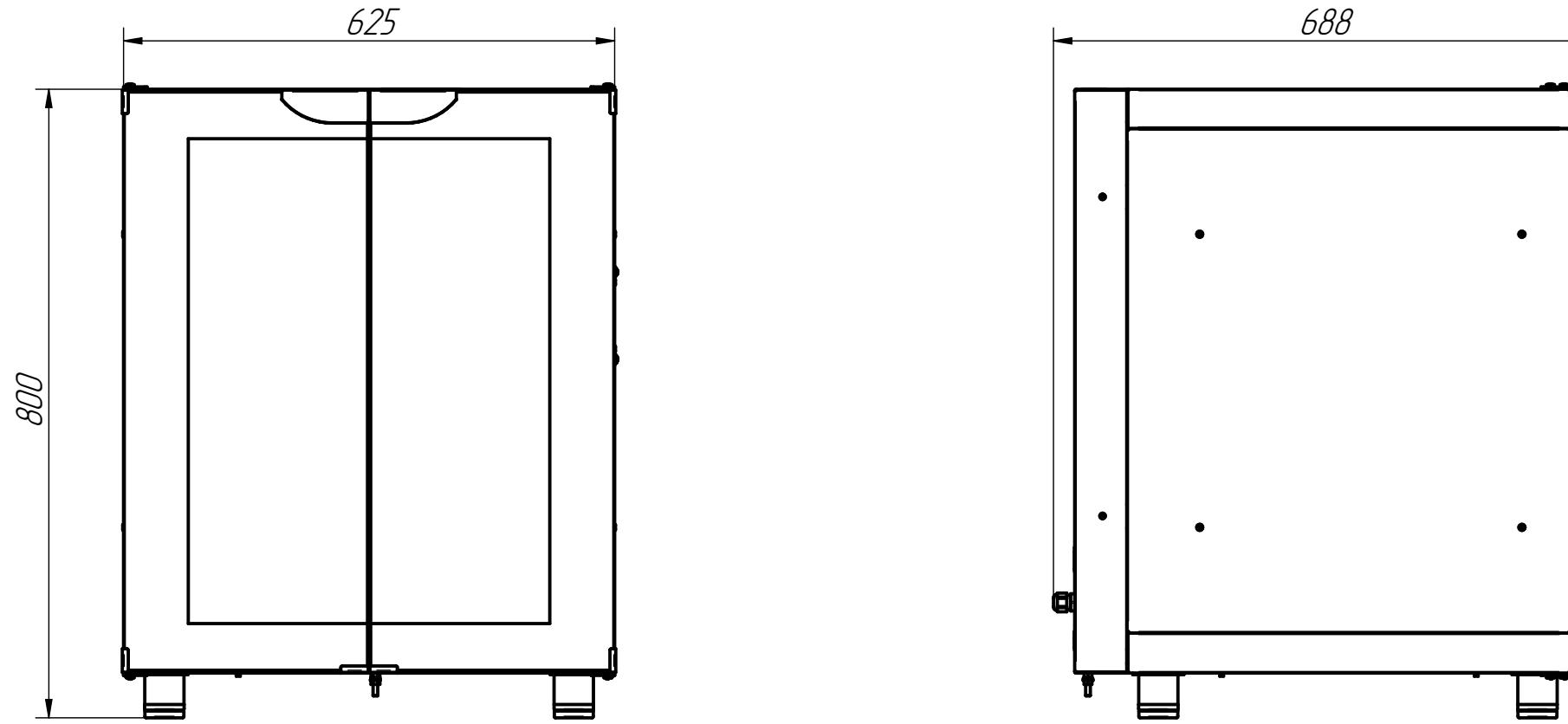
Шкаф расстоечный тепловой предназначен для расстойки мелкоштучных хлебобулочных и кондитерских изделий на предприятиях общественного питания. Основной режим работы – расстойка продукта при температуре 45 ° С. Шкаф может использоваться на предприятиях общественного питания как самостоятельно, так и в составе технологической линии. Камера и наружные поверхности выполнены из высококачественной нержавеющей стали.
