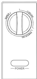
Необходимая температура в морозильном ларе устанавливается и контролируется с помощью панели управления. Панель управления представлена ручкой термостата и индикатором зеленого цвета. Зеленый индикатор на панели управления означает, что ларь включен в сеть. Регулировка температуры осуществляется с помощью термостата в пределах от +10°C до -24°C в соответствии с режимами:
