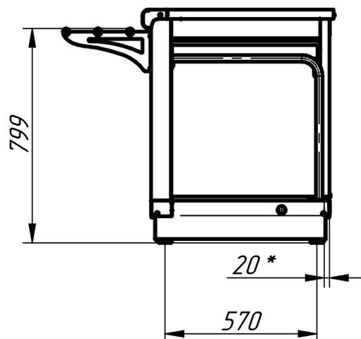
Кассовая кабина предназначена для установки на нем кассового аппарата и расчета с потребителями. Внизу имеется дополнительная полка и розетка 230В для подключения кассового аппарата. Путем несложного монтажа можно установить кассовую кабину как в левом, так и в правом исполнении. Направляющие для подносов входят в комплект поставки. Прилавок имеет регулируемые по высоте ножки. Столешница и направляющие для подносов изготовлены из нержавеющей стали.
