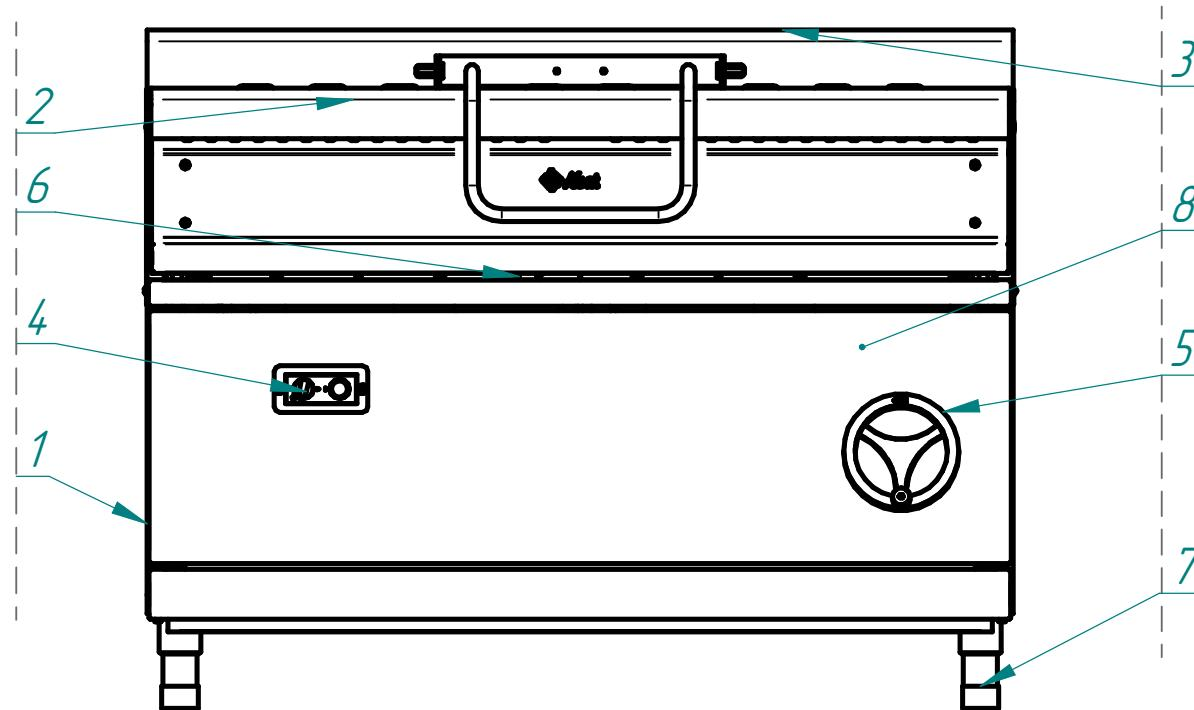
1. Корпус; 2. Крышка; 3. Воздуховод; 4. Комбинированный газовый кран; 5. Штурвал; 6. Смотровое отверстие; 7. Регулируемые ножки; 8. Панель передняя.
