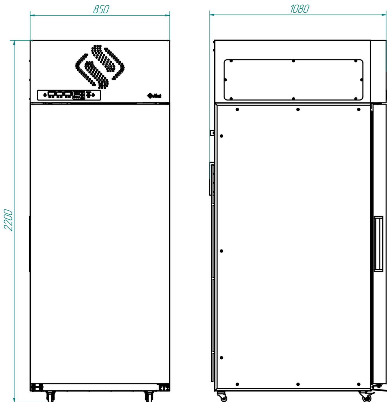
Шкаф шоковой заморозки ШОК-20-1/1 предназначен для быстрого охлаждения и замораживания различных пищевых продуктов на предприятиях общественного питания и торговли.
