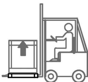
Погрузка/выгрузка шкафа выполняются с помощью гидравлической тележки или вилочного погрузчика, управляемых уполномоченными опытными лицами. Мы не несем ответственности за игнорирование действующих правил техники безопасности.
