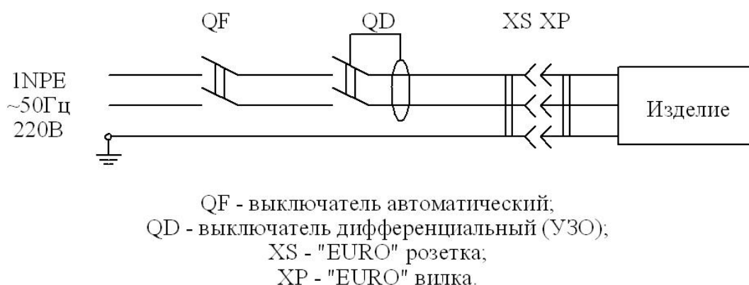
Рис. 1. Схема подключения изделия к электросети.
