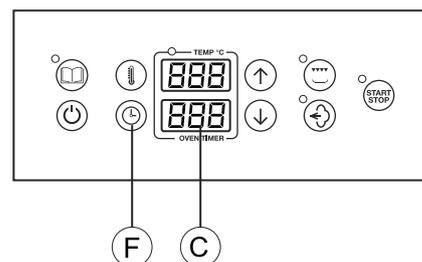
Для установки работы без ограничения времени (неограниченное время) нужно нажать кнопку, изображенную сбоку, когда на экране указано значение 0. На экране отобразится ---.
