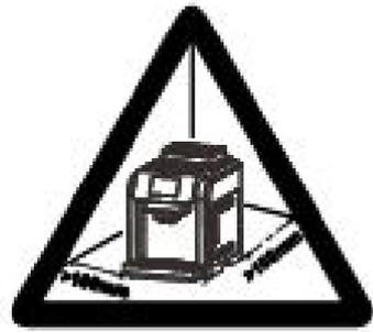
Установите кофемашину на ровную и плоскую поверхность. Расстояние между кофемашинной и стеной не должно быть меньше 100 мм
