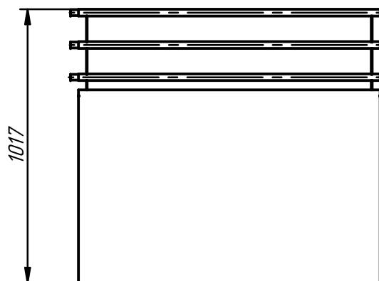
Прилавок для горячих напитков (нейтральный стол) предназначен для кратковременного хранения и раздачи потребителю хлебобулочных и кондитерских изделий, а также для установки на его столе термостата с напитками. На прилавке установлена розетка 230 В для подключения термостата или кипятильника. Внизу нейтральный шкаф для хранения кухонного инвентаря. Направляющие для подносов входят в комплект поставки. Прилавок имеет регулируемые по высоте ножки.
