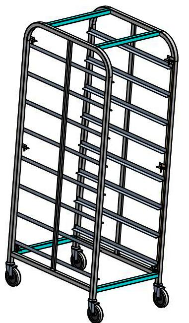
Тележка шпилька для подносов является вспомогательным оборудованием для предприятий общественного питания и используется для установки и транспортировки 8 подносов размером 430x550 мм. Тележка имеет поворотные колеса, два из которых оборудованы стопором.
